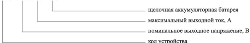
В УЭПС-Щ при полной комплектации входят функциональные узлы и устройства, указанные в табл. 17.
